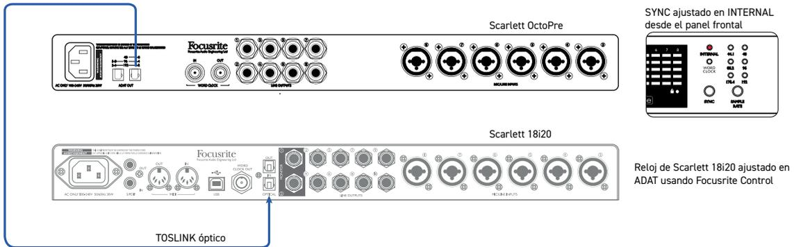
En este ejemplo, ADAT OUT en Scarlett OctoPre está conectada a OPTICAL IN en una interfaz de audio Scarlett 18i20 con un solo cable óptico. Ambas unidades usan una tasa de muestreo de 44,1 kHz. La fuente del reloj de OctoPre está ajustada en INTERNAL y 18i20 está sincronizada a dicha fuente porque su fuente de reloj está ajustada en ADAT (a través de Focusrite Control).
