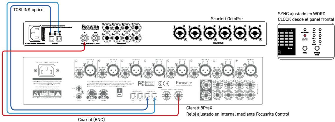
Este ejemplo muestra una configuración similar a la indicada en el ejemplo 2, sin embargo, al usar una Focusrite Clarett 8PreX, podrá utilizar una tasa de muestreo de 96 kHz (modo “SMUX-II”). Ambas unidades deben estar ajustadas en 96 kHz; se usan dos cables ópticos que transportan cuatro canales de audio cada uno. Clarett 8PreX es la maestra de la sincronización.
